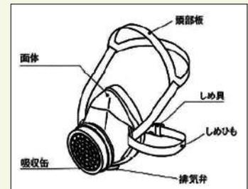
▲図2 土壌くん蒸用防護マスクの構造
