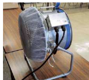
写真1 簡易的な外気導入装置 (ダクトを付けて使用)
